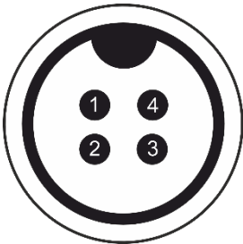
Схема контактов разъёма 4 PIN (папа) кабеля видеовхода AV IN3
