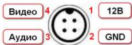
Схема контактов коннектора 4 pin (папа) - RCA разъёма переходника
