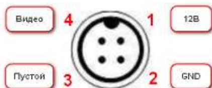
Схема контактов коннектора 4 pin (папа) разъёма кабеля монитора
